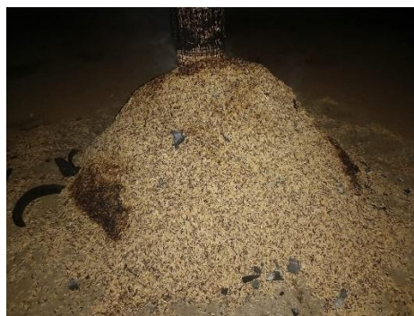
Gambar 4. Fase Awal Pembakaran
