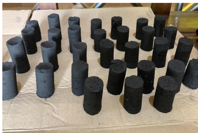
Gambar 5. Proses Pengeringan Briket
