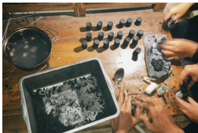
Gambar 4. Proses Mencampur Bonggol Jagung halus dengan Tepung Perekat serta Pembentukan Briket
